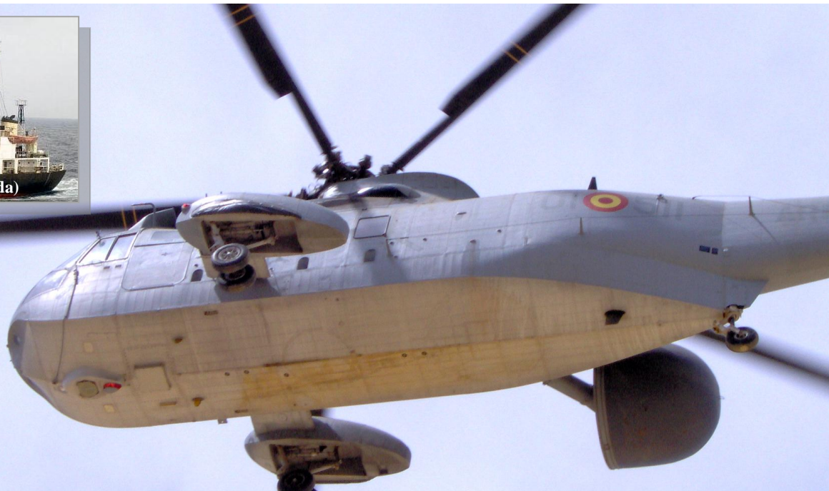
Imagen del 01-511 que nos muestra la “quilla” de su fuselaje diseñado para permitirle navegar en caso de amerizaje. También destaca en posición recogida, el radomo inflado que contiene en su interior el radar Searchwater de la versión AEW (Foto: M. Lucena)
