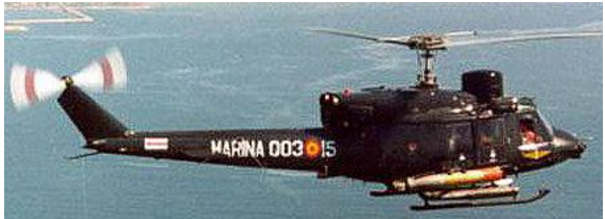
AB-212, armado con un torpedo Mk-46, luce el azul marino inicial y MARINA en su fuselaje. Se cambiaría después por ARMADA y el color gris claro (Foto: Armada)
